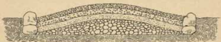
Fig. 18. — Coupe de la voie romaine de Carthage à Tébessa, d'après M. le Dr Carton.
