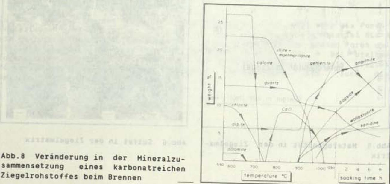
Abb.8 Veränderung in der Mineralzusammensetzung eines karbonatreichen Ziegelrohstoffs beim Brennen
