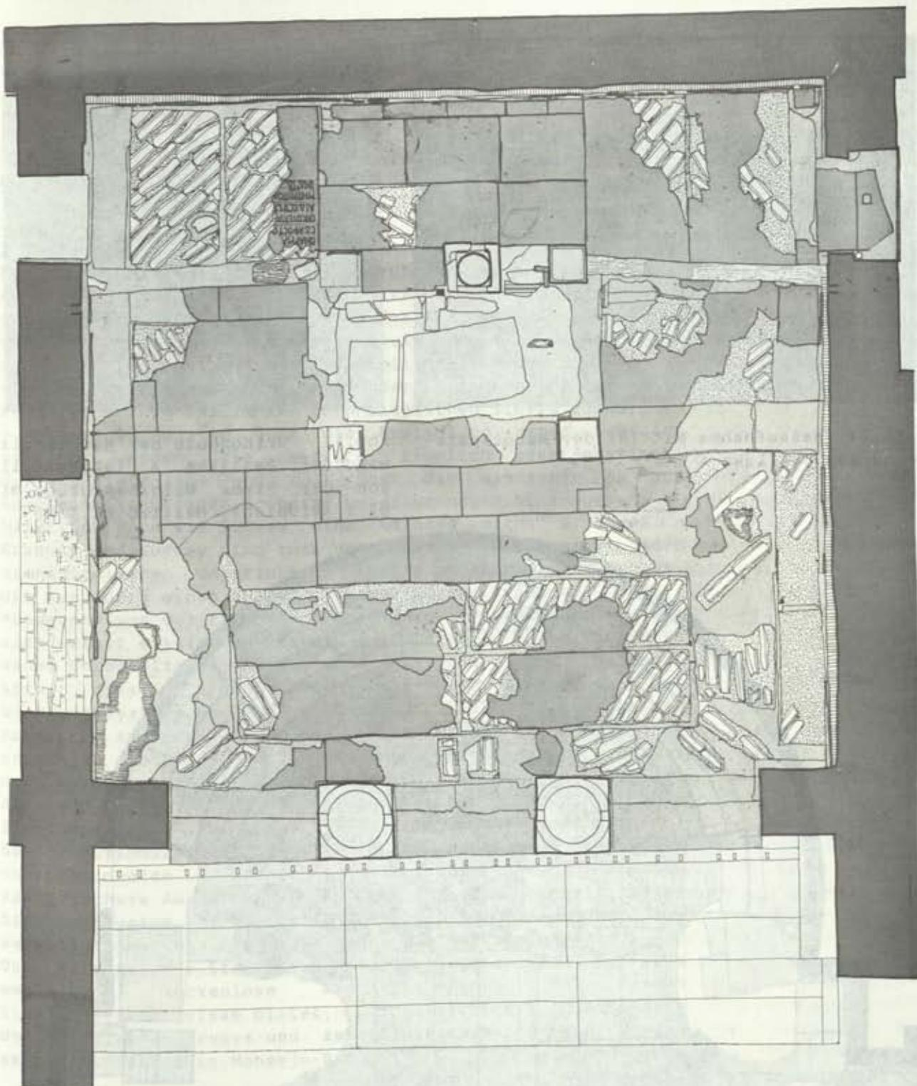
Abb.10 Photogrammetrische Fußbodenauflistung des östlichen Vorraums, nördliches Seitenschiff der Basilika A (nach Bearbeitung durch den Bauhistoriker), Maßstab ca.1:50, Aufnahme mit Wild P32
